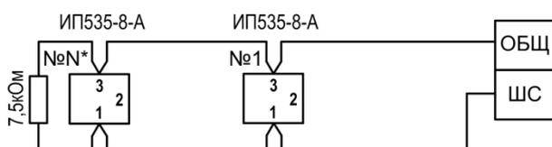
Рис. 1 Схема подключения ИП535-8А по алгоритму А.
